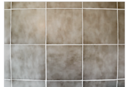
Abb. 2-12 Fliesen eignen sich hervorragend, um die Verzeichnung eines Weitwinkelobjektivs sichtbar zu machen.
