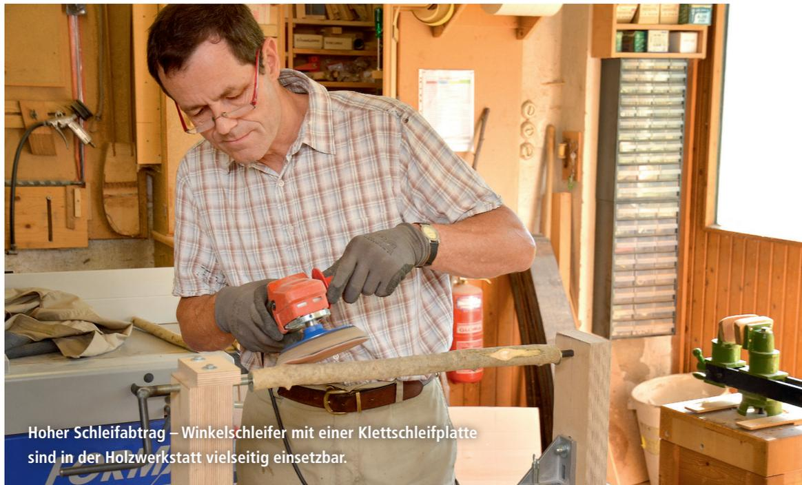
Hoher Schleifabtrag – Winkelschleifer mit einer Klettschleifplatte sind in der Holzwerkstatt vielseitig einsetzbar.
